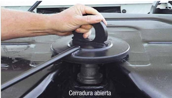
Inserte una herramienta de prueba dimensionalmente correcta en la garganta de la quinta rueda. Empuje cuidadosamente el cabezal hasta que se active el mecanismo de cierre. Mantenga las manos fuera de la garganta de la quinta rueda.
