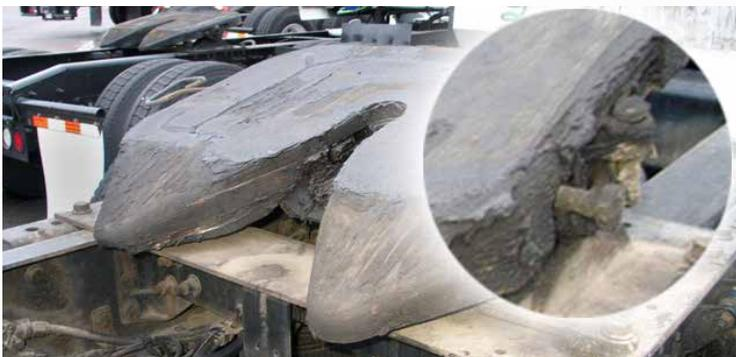
La sobre-lubricación es costosa y causa la acumulación excesiva—para arriba en los componentes de la quinta rueda que conducen a ingresos perdidos.
