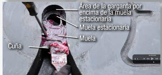
Separar la muela y la cuña con un tornillo y presionar el lubricante recomendado entre las superficies dentadas. Trabajar el pull-handle de ida y vuelta para extender el lubricante sobre todas las superficies. También engrasar la mandíbula estacionaria y el área de la garganta por encima de la mandíbula estacionaria.
