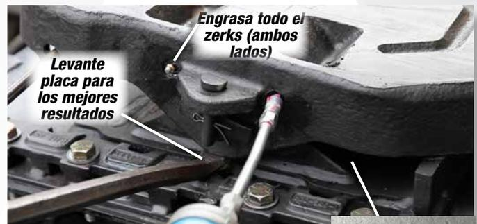
**Engrasar los soportes de montaje.** Levante la placa superior con una barra de palanca para asegurarse de que la grasa llega a la parte superior de los soportes. (Inspeccionar la base del soporte de montaje, y si "LUBE FREE" se vierte en el soporte omitir este paso. Estos modelos tienen forros de soporte y no requieren lubricación. **En este caso inspeccionar forros de desgaste**). En caso de frío, consulte la página 27.
