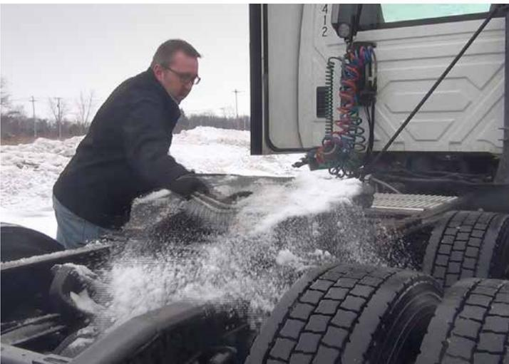
**2** Lubricar la placa superior y el mecanismo de bloqueo.
